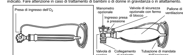
Figura n.1: pallone di iperventilazione con manometro, Vista anteriore Figura n.2: pallone di iperventilazione con manometro e valvola di sicurezza opzionale, Vista laterale
